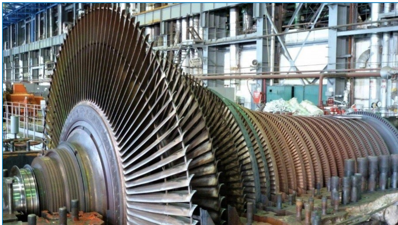
Рисунок 1. Консервация паровой турбины. Проточная часть.
